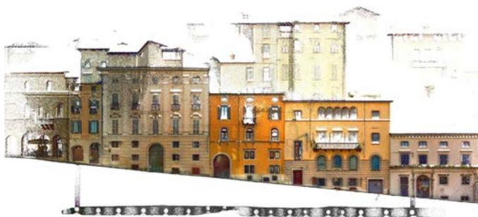
*Sezione longitudinale della nuvola di punti*
