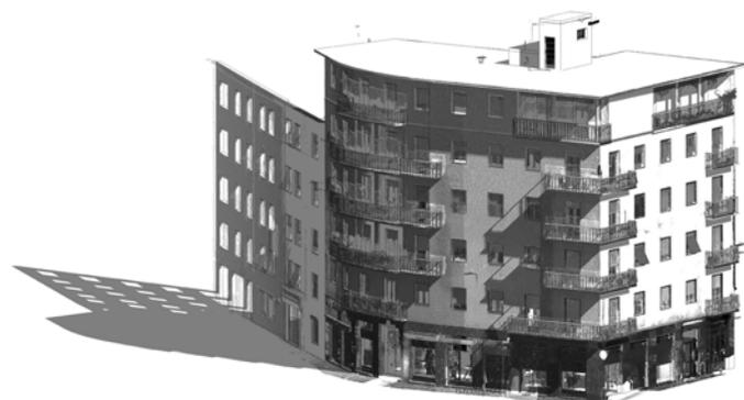
*Sovrapposizione della nuvola di punti e del modello BIM*
