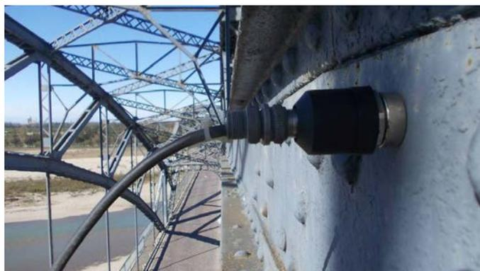
*Dettaglio dell'accelerometro di misura su arco*
