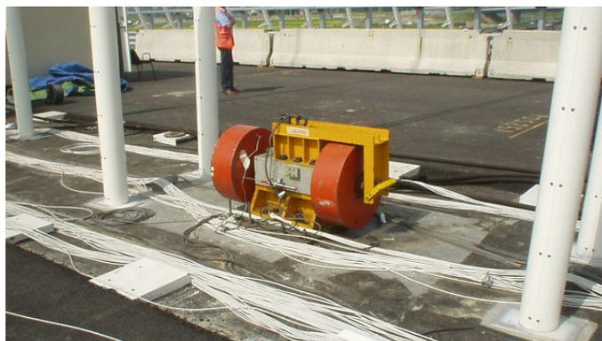
*Posizione della vibrodina per prova dinamica*
