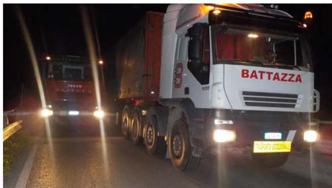
*Mezzi per la prova di carico*
