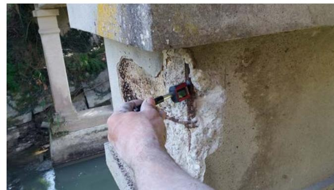
*Esecuzione di prova con durometro*
