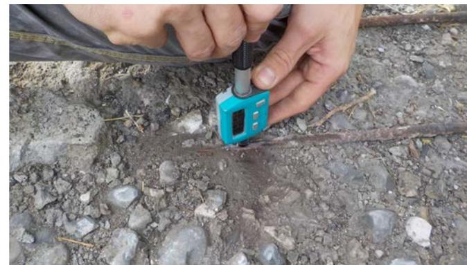
*Prova con durometro su barra d'armatura*
