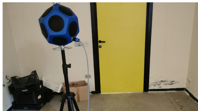
Misura del potere fonoisolante apparente di parete
