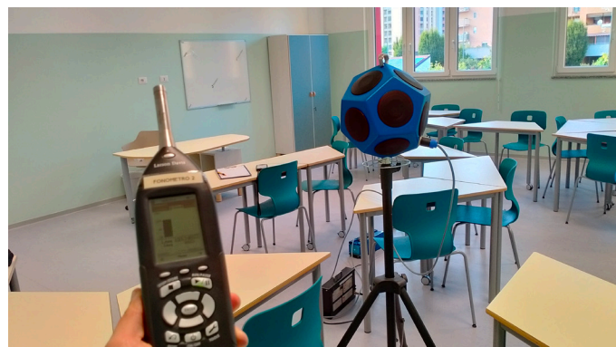
Misura del potere fonoisolante apparente di parete
