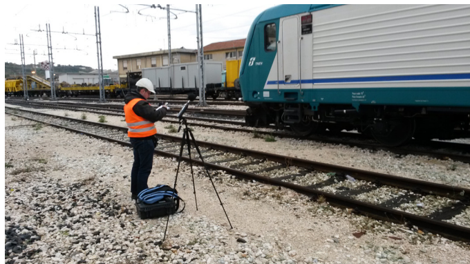
Postazione fonometrica all'interno del sedime ferroviario
