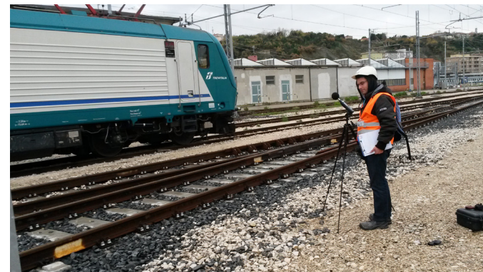
Postazione fonometrica all'interno del sedime ferroviario
