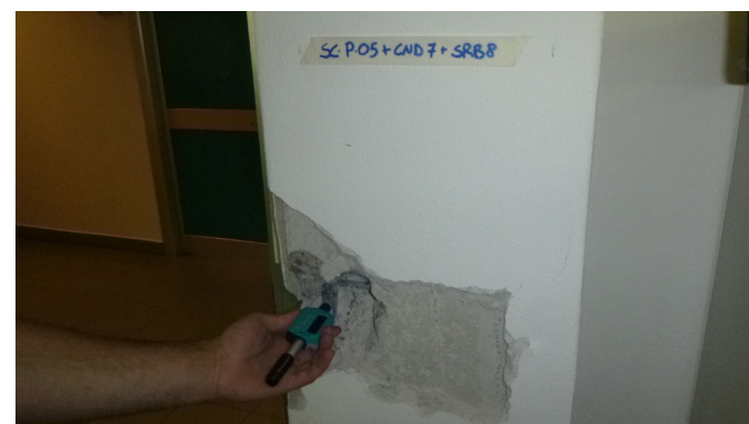
Prova durometrica per caratterizzazione dell'acciaio
