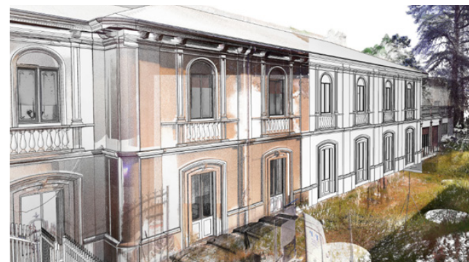
Vista prospettica del modello BIM con sovrapposizione nuvola
