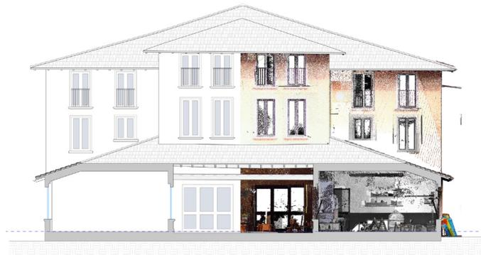
*Sezione longitudinale con nuvola di punti*
