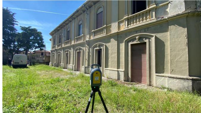
*Operazione di rilievo con Laser Scanner*
