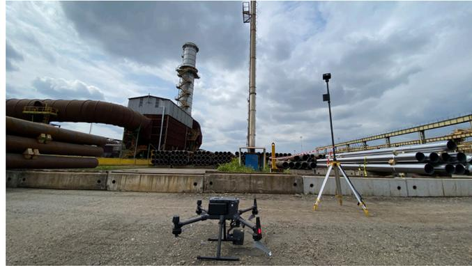
Operazione di rilievo con Laser Scanner
