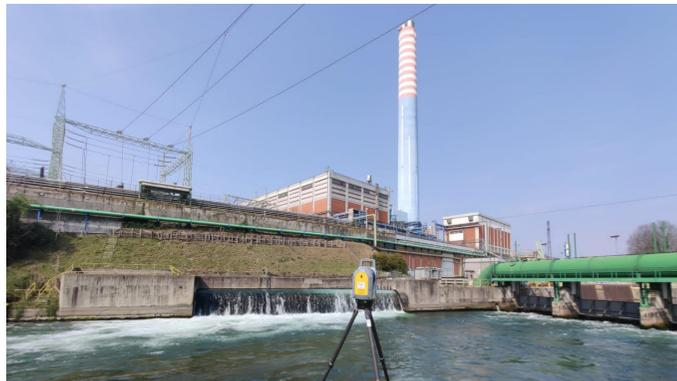
*Operazione di rilievo con Laser Scanner*
