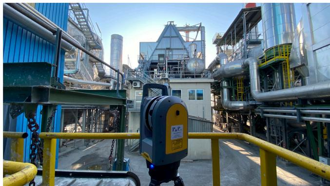
*Operazione di rilievo con Laser Scanner*
