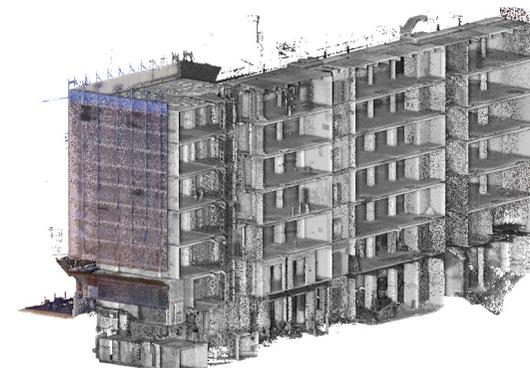
*Sezione longitudinale della nuvola di punti dell'immobile*
