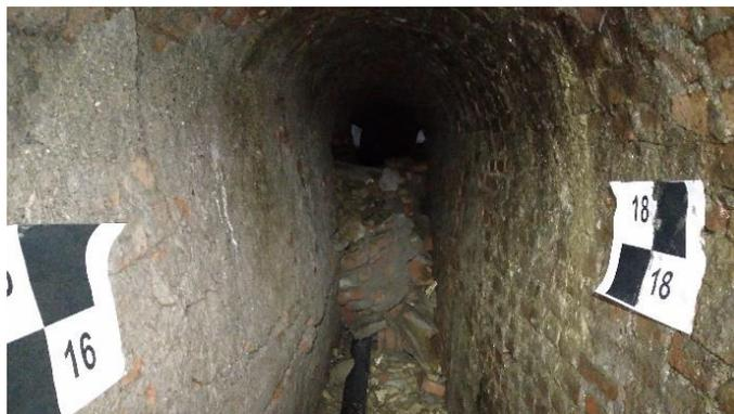
*Operazioni di rilievo con il Laser Scanner all'interno del cunicolo*
