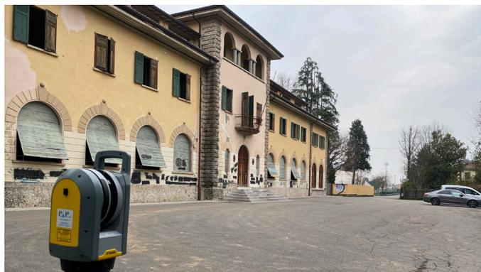
*Operazione di rilievo con Laser Scanner*
