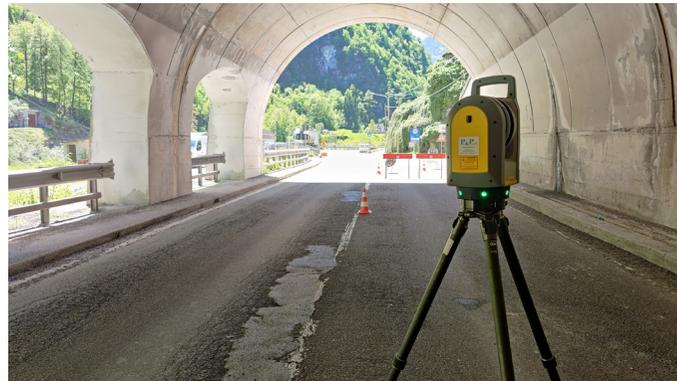
*Operazione di rilievo con Laser Scanner*
