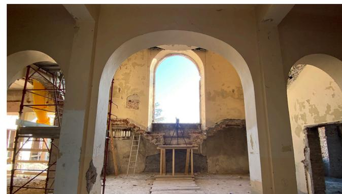
*Operazione di rilievo con Laser Scanner*
