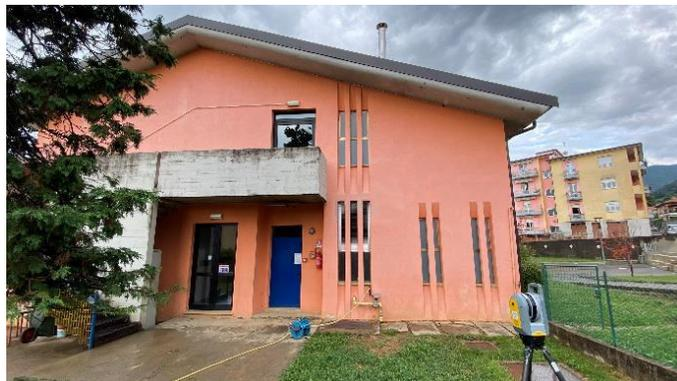
*Operazione di rilievo con Laser Scanner*
