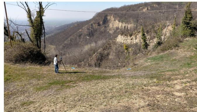
*Operazione di rilievo con Laser Scanner*
