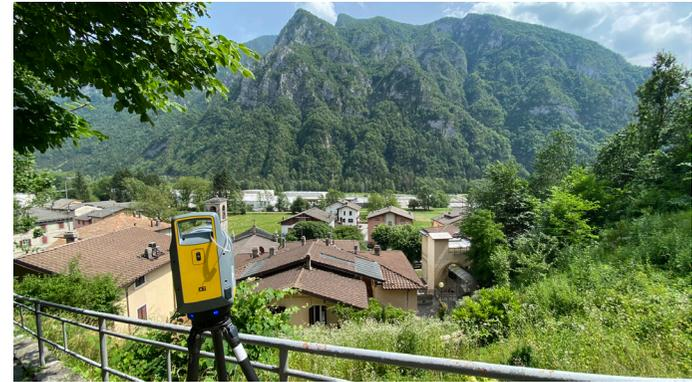
*Operazione di rilievo con Laser Scanner*
