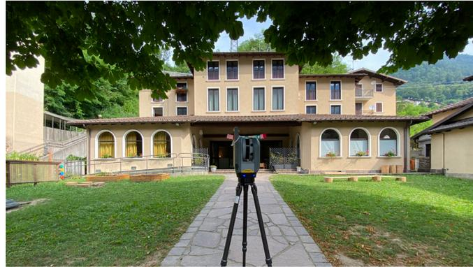
*Operazione di rilievo con Laser Scanner*
