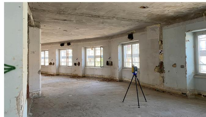
*Operazioni di rilievo con Laser Scanner*
