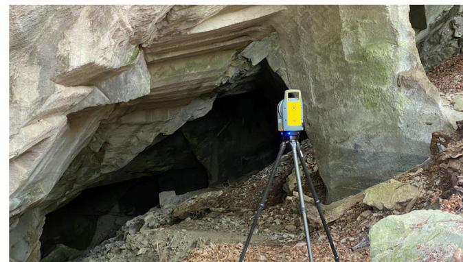
*Operazioni di rilievo con Laser Scanner*
