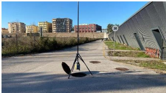
*Operazione di rilievo pozzetti d'ispezione con Laser Scanner*
