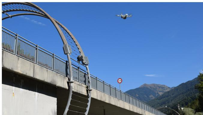
*Rilievo fotogrammetrico di manufatto stradale*
