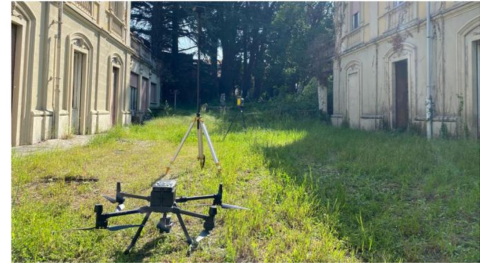
*Operazione di rilievo con Laser Scanner*
