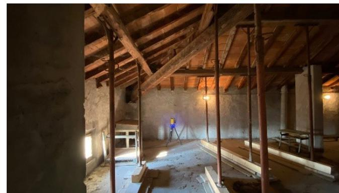
Operazione di rilievo con Laser Scanner
