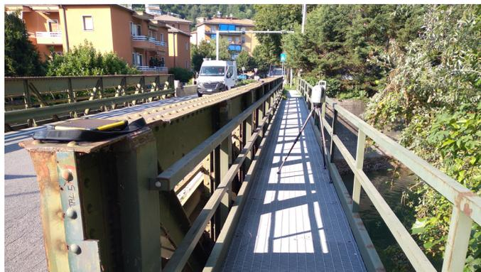
Operazione di rilievo con Laser Scanner
