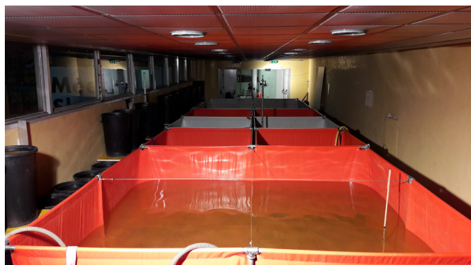
Esecuzione di prova di carico della passerella verso via Giolitti
