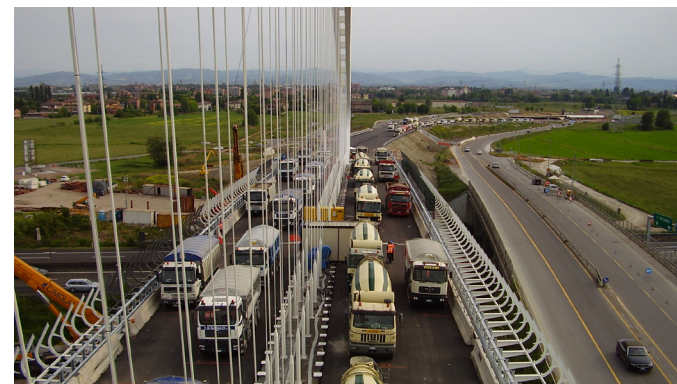
Prova di carico globale
