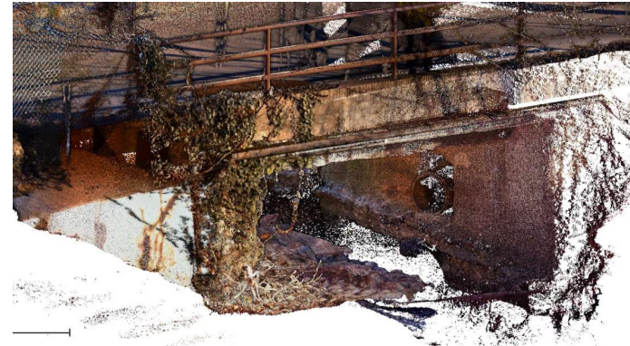
Nuvola di punti del ponte ottenuta tramite laser scanner
