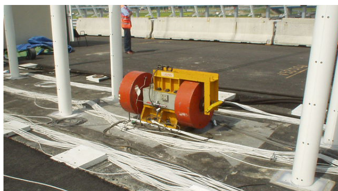
Posizione della vibrodina per prova dinamica
