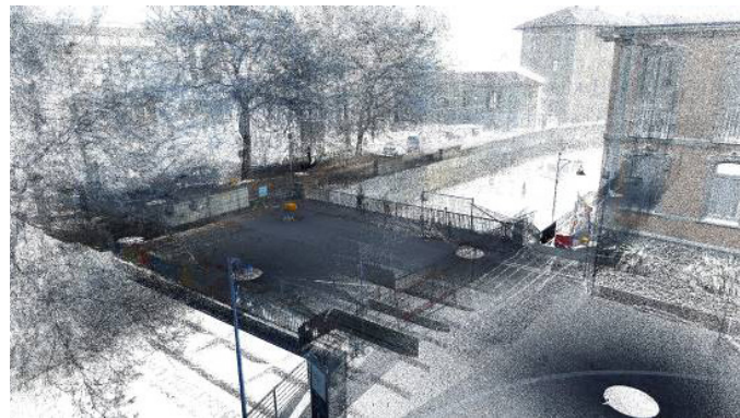
Nuvola di punti da laser scanner e drone del ponte esistente
