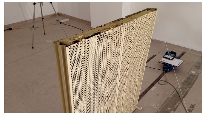
Misura dell'assorbimento acustico in camera riverberante
