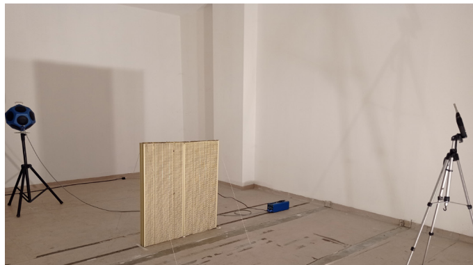
Misura dell'assorbimento acustico in camera riverberante
