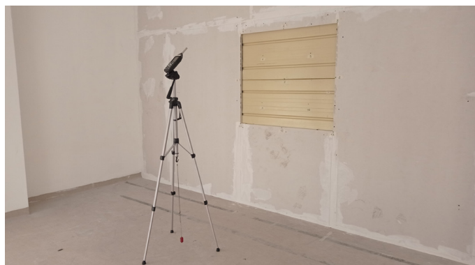
Misura dell'isolamento acustico in camera riverberante
