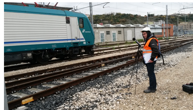
Postazione fonometrica all'interno del sedime ferroviario
