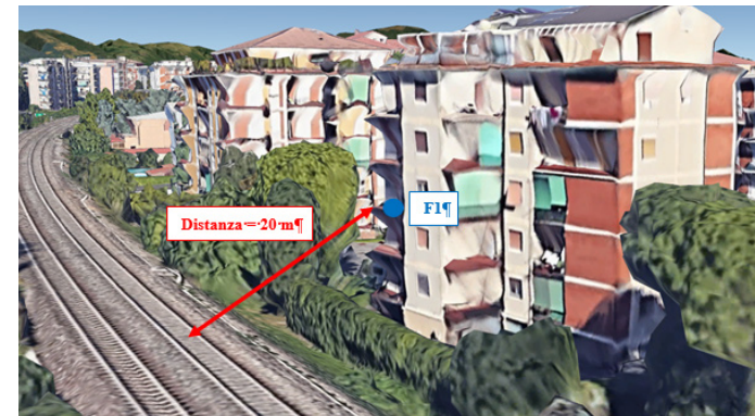
Posizione del punto di misura rispetto alla linea ferroviaria
