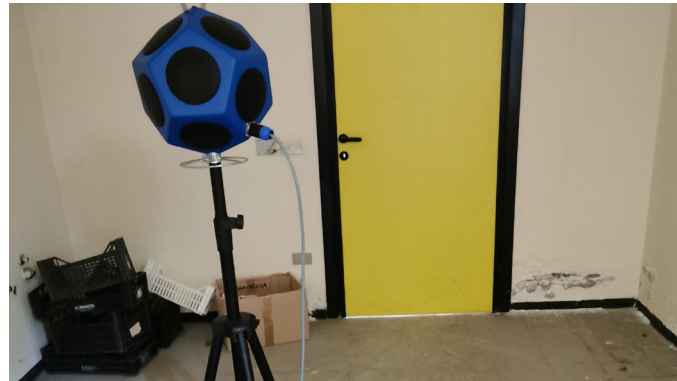
Misura del potere fonoisolante apparente di parete
