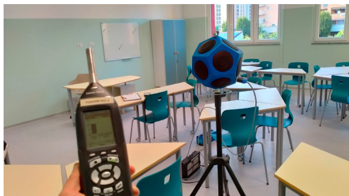
Misura del potere fonoisolante apparente di parete
