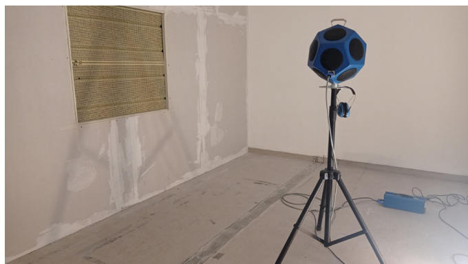
Misura dell'assorbimento acustico in camera riverberante
