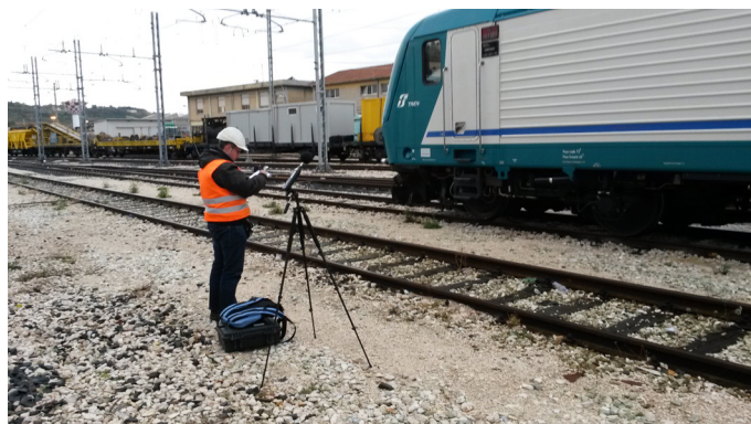
Postazione fonometrica all'interno del sedime ferroviario
