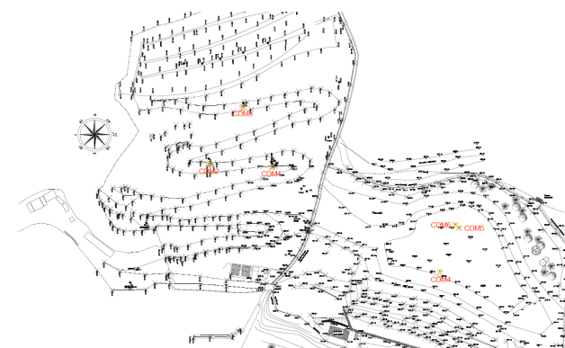
Planimetria con dislocazione dei n.6 tubi inclinometrici
