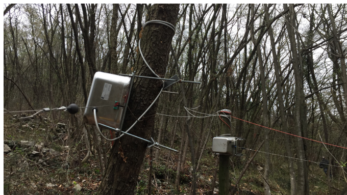
Estensimetri a filo sezione d'estremità
