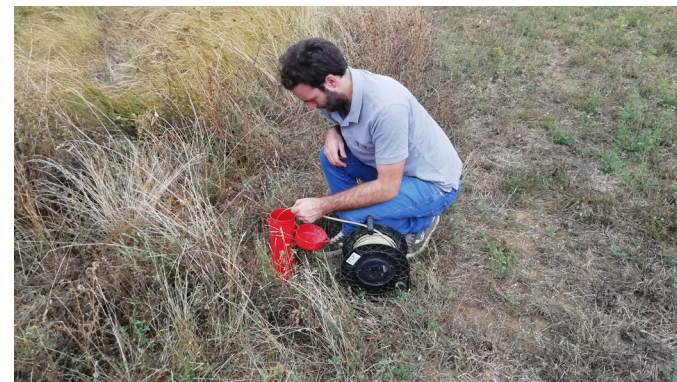
Misura con freattimetro
