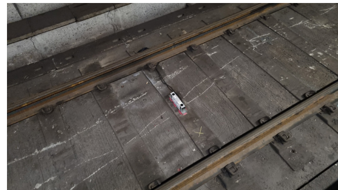
Inclinometro per rilevazione della geometria del binario
