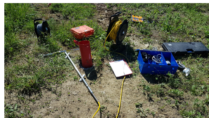
Attrezzatura per le letture inclinometriche
