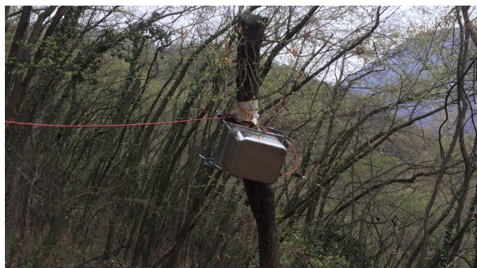
Estensimetri a filo sezione centrale
