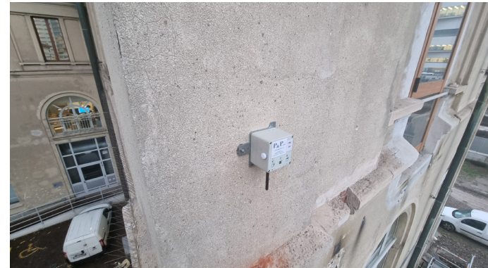
Installazione tipo inclinometro da parete
