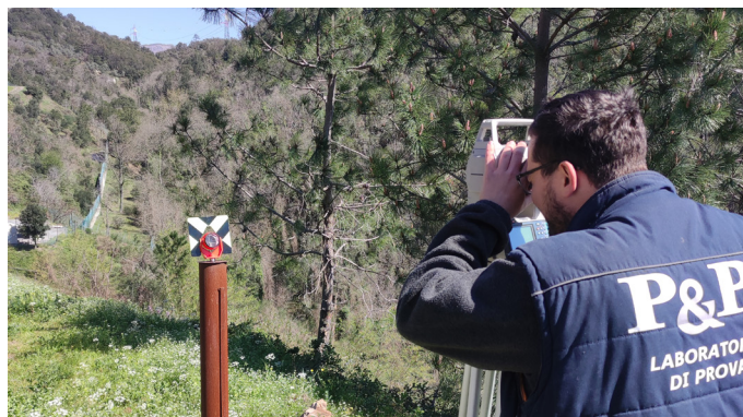
Operazione di lettura di mira su testa di tubo inclinometrico
