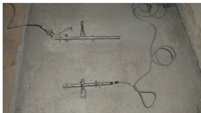
Monitoraggio della deformata tramite sensore di spostamento
