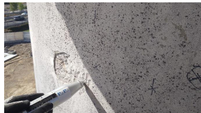
Prova sclerometrica per determinazione della resistenza del cls
