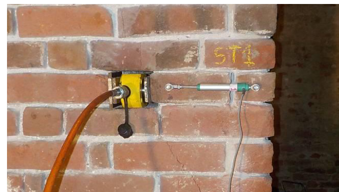
Esecuzione di prova shove test
