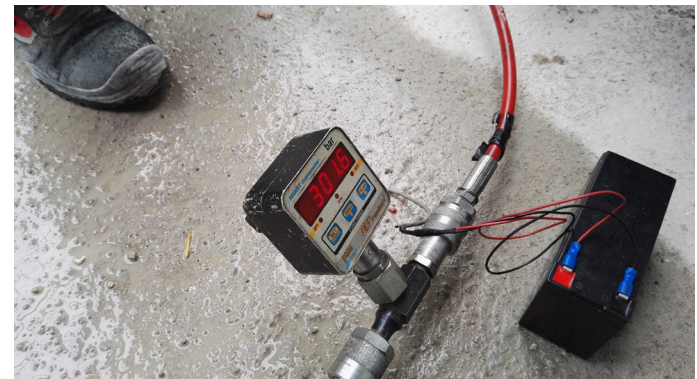
Cella di carico durante l'esecuzione della prova
