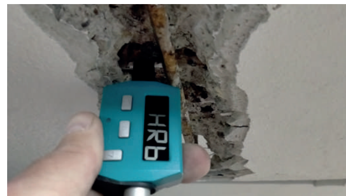
Durometro per caratterizzazione dell’acciaio
