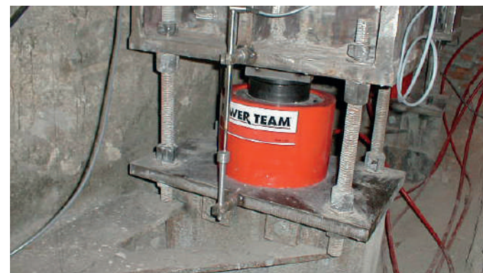
Dettaglio di attuatore da 280 ton con relativo flessimetro
