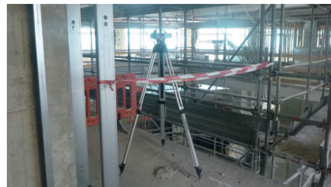
Livello ottico digitale per il monitoraggio degli spostamenti
