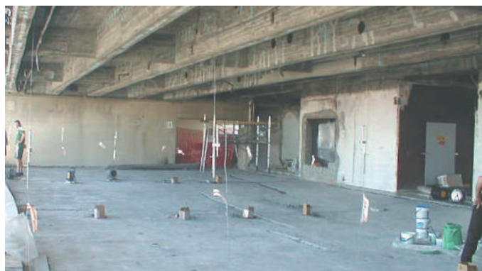
Sistema di trasduttori di spostamento impiegato
