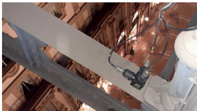
Terna accelerometrica per prova dinamica
