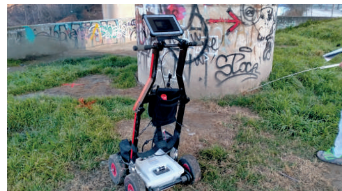
Indagine georadar su fondazione di pila
