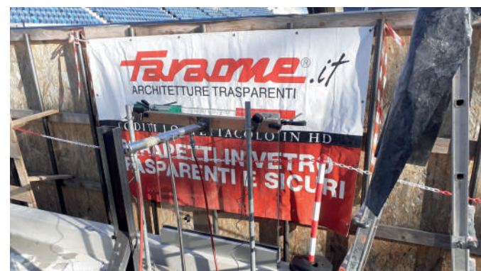
Prova di carico a spinta su parapetto tramite martinetto
