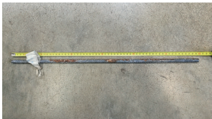
Barra d'armatura estratta
