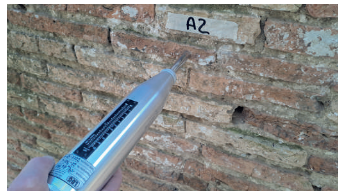
Prova sclerometrica su mattone
