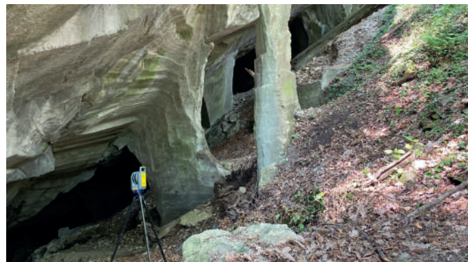
Rilievo tramite laser scanner
