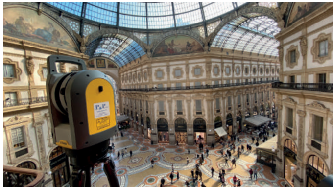
Operazione di rilievo con Laser Scanner
