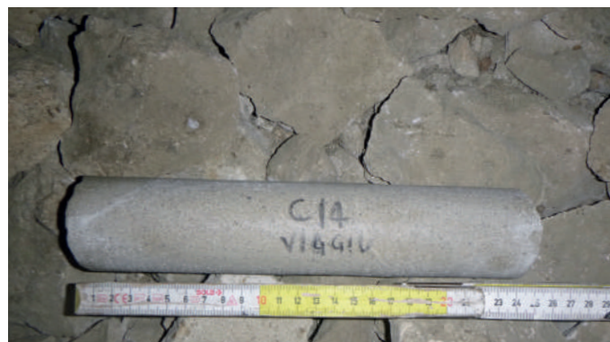
Carota estratta per essere sottoposta a prova di laboratorio
