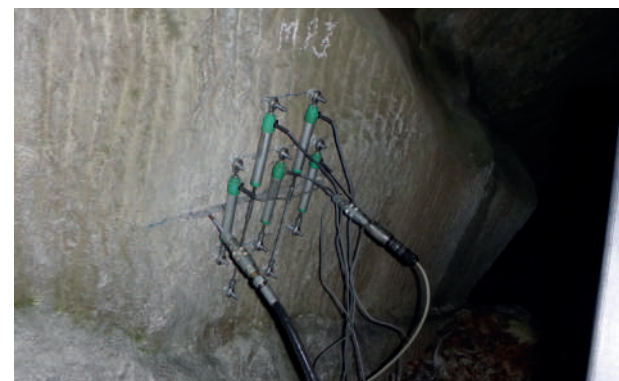
Esecuzione di martinetto piatto singolo su roccia
