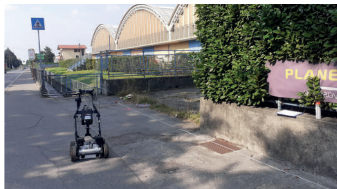
Esecuzione di georadar preliminare ai sondaggi
