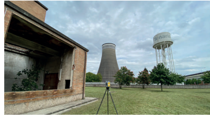
Operazioni di rilievo con Laser Scanner
