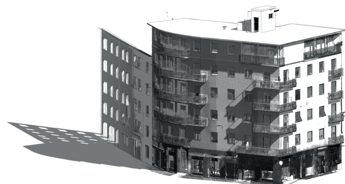
Sovrapposizione della nuvola di punti e del modello BIM
