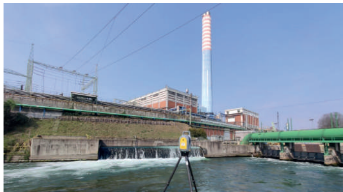
Operazione di rilievo con Laser Scanner
