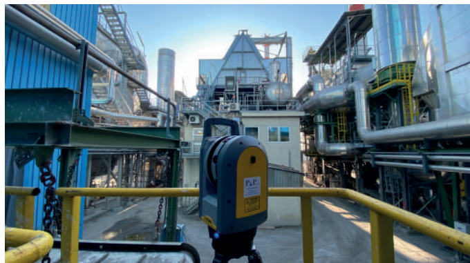
Operazione di rilievo con Laser Scanner
