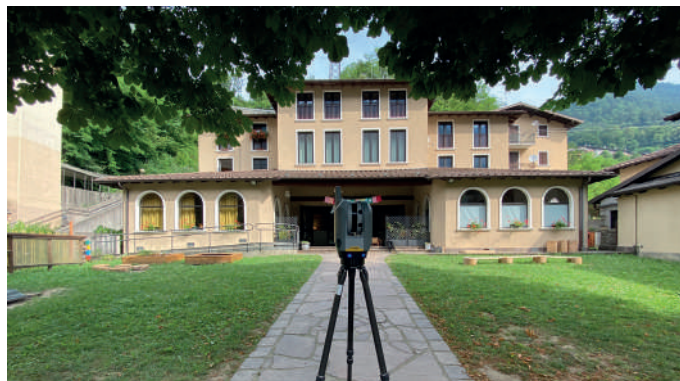
Operazione di rilievo con Laser Scanner
