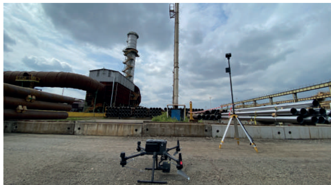
Operazione di rilievo con Laser Scanner
