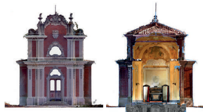
Prospetto e sezione trasversale da nuvola di punti
