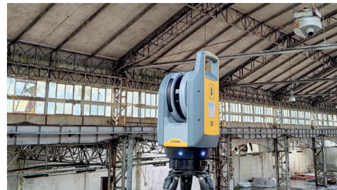
Dettaglio della strumentazione Laser Scanner
