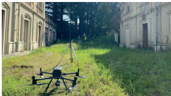
Rilievo fotogrammetrico di villa storica
