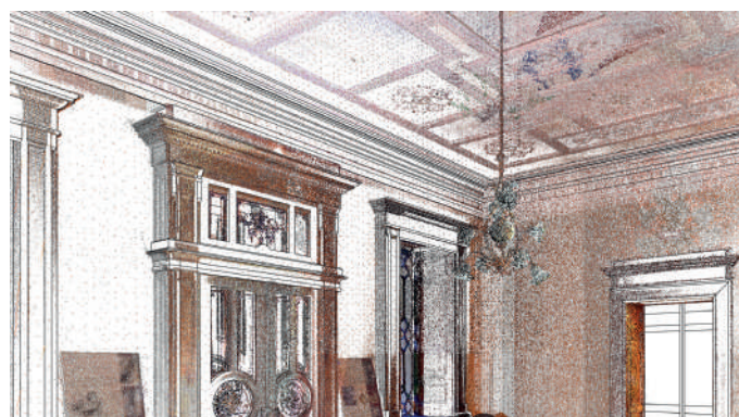
Vista interna della nuvola di punti con modello 3D
