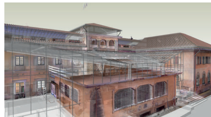
Vista prospettica del modello BIM e della nuvola di punti
