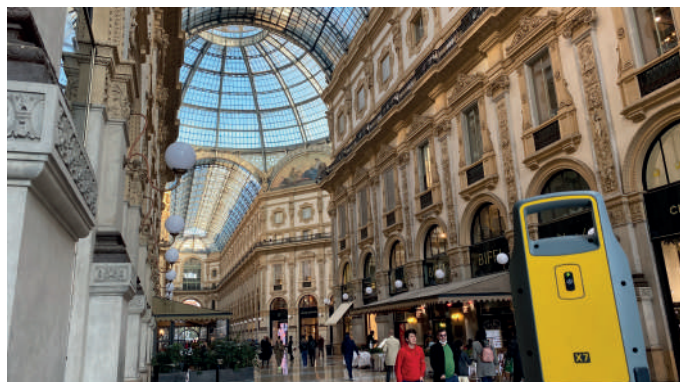
Operazione di rilievo con Laser Scanner
