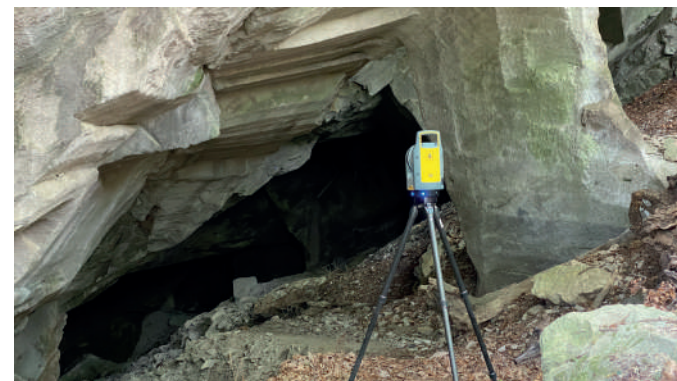
Operazioni di rilievo con Laser Scanner
