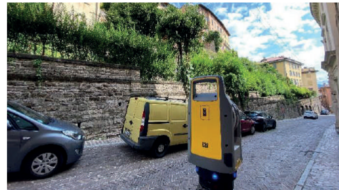
Operazioni di rilievo con Laser Scanner al di sopra del cunicolo
