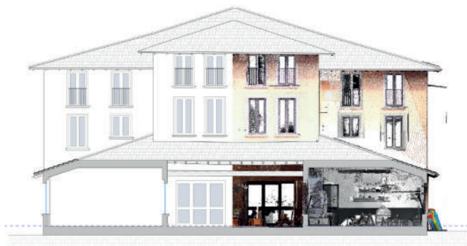
Sezione longitudinale con nuvola di punti
