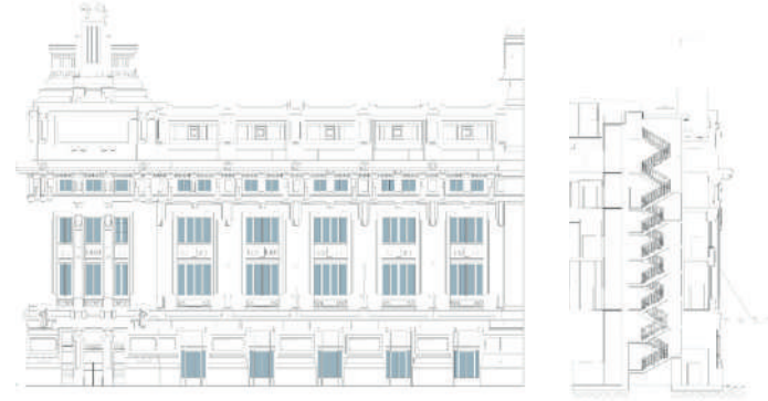
Prospetto e sezione ricavati da nuvola di punti
