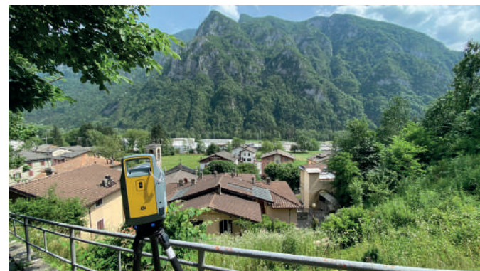
Operazione di rilievo con Laser Scanner
