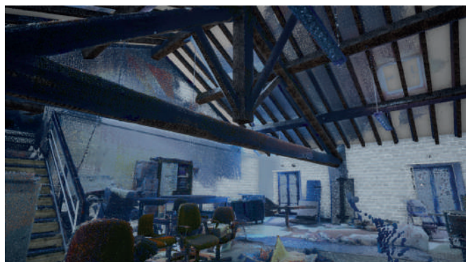
Vista prospettica del modello BIM sovrapposto alla nuvola
