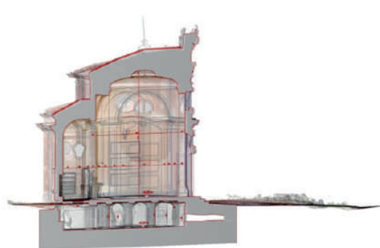
Sezione longitudinale da nuvola di punti
