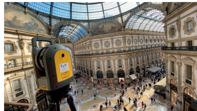
Operazione di rilievo con Laser Scanner
