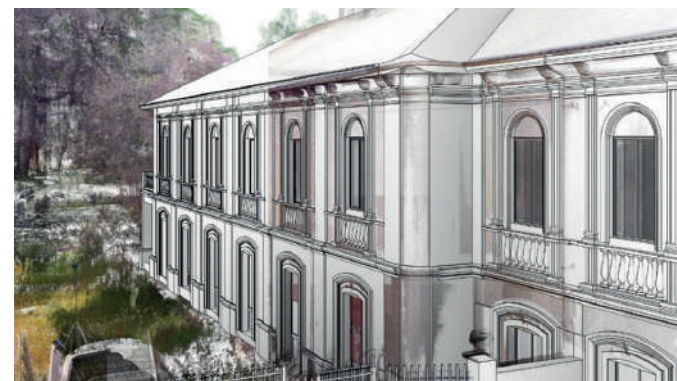
Vista prospettica del modello BIM con sovrapposizione nuvola
