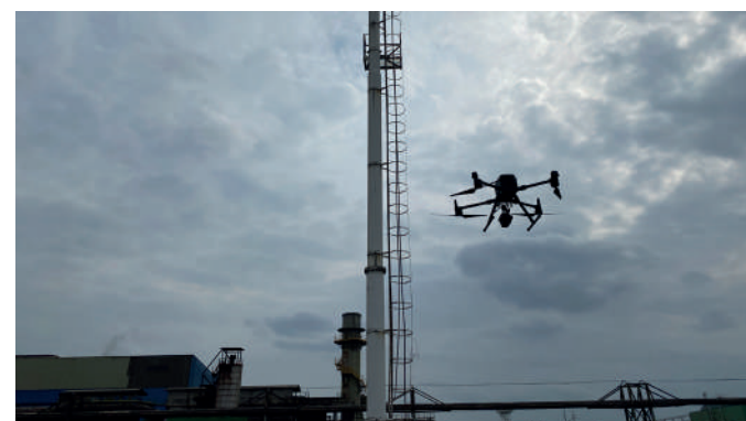
Ispezione di torre faro
