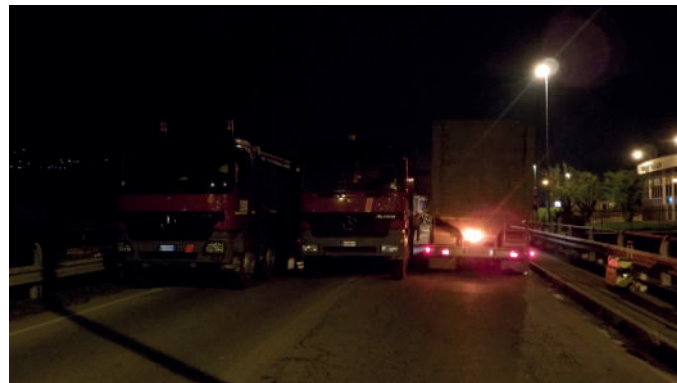
Posizionamento dei mezzi per la prova di carico
