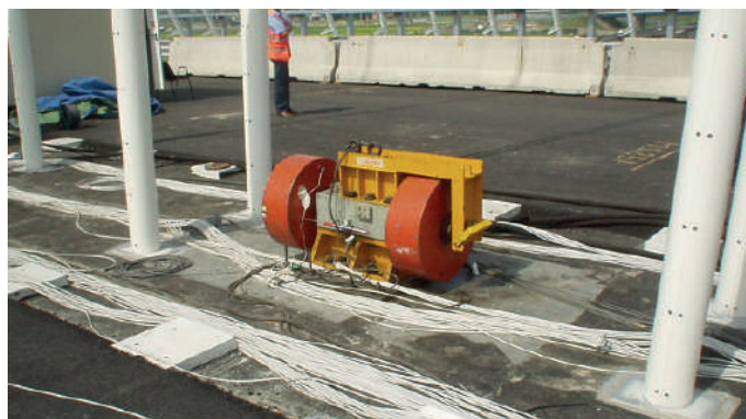
Posizione della vibrodina per prova dinamica
