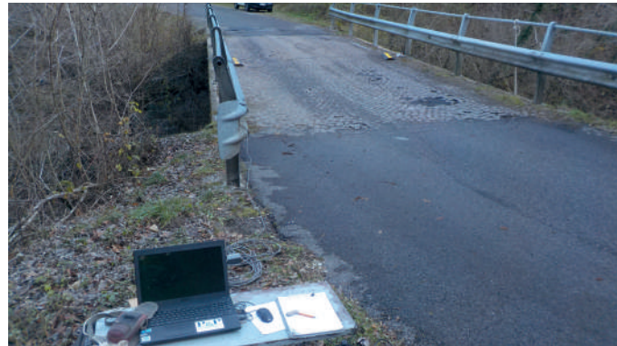
Esecuzione della prova dinamica
