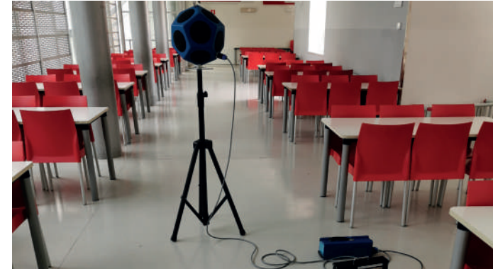
Determinazione del tempo di riverbero in mensa
