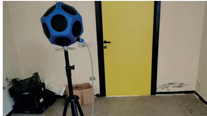
Misura del potere fonoisolante apparente di parete
