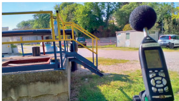
Misurazioni fonometriche per valutazioni di impatto acustico
