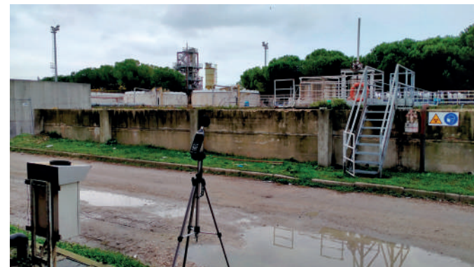
Misurazioni fonometriche per valutazioni di impatto acustico
