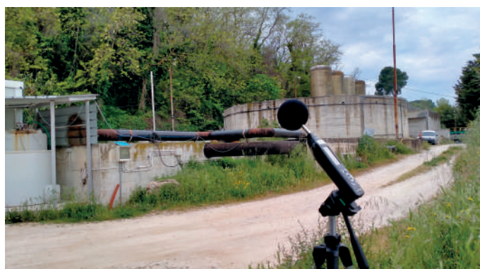
Misurazioni fonometriche per valutazioni di impatto acustico
