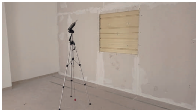
Misura dell'isolamento acustico in camera riverberante
