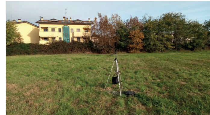
Postazioni fonometriche per la valutazione del clima acustico della futura area del polo scolastico
