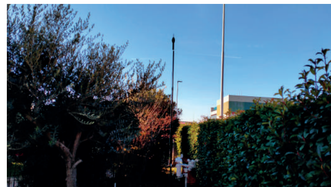
Postazione fonometrica presso ricettore privato per la valutazione del clima acustico in Ante Operam
