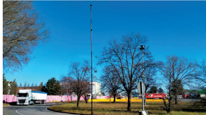
Misurazioni fonometriche per valutazioni di impatto acustico
