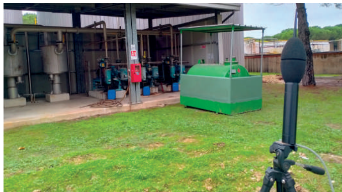
Misurazioni fonometriche per valutazioni di impatto acustico
