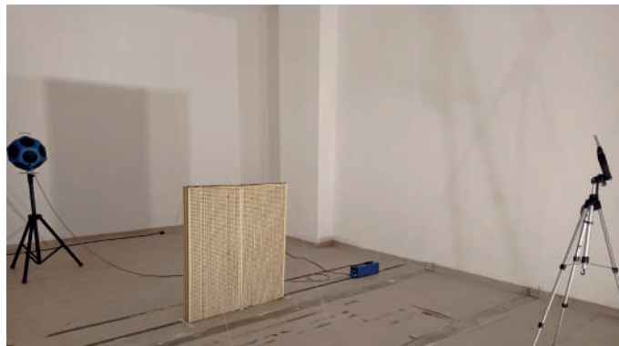
Misura dell'assorbimento acustico in camera riverberante
