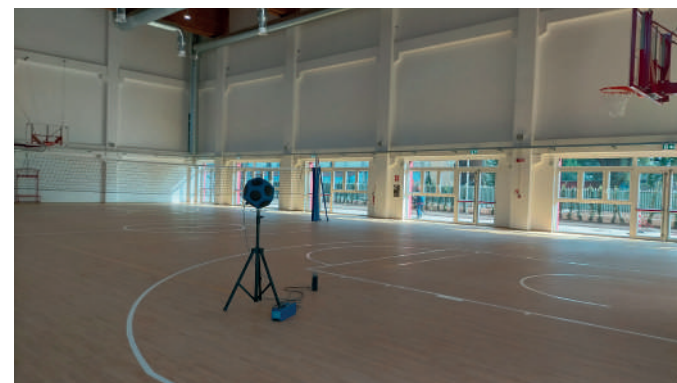
Determinazione del tempo di riverbero nella palestra
