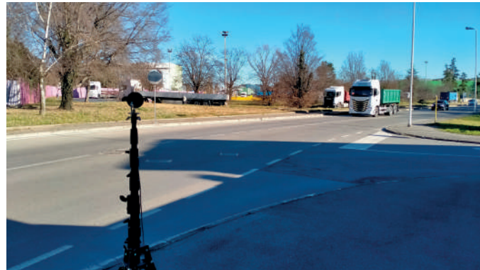
Misurazioni fonometriche relative al traffico stradale
