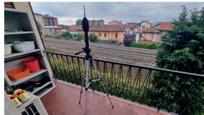
Postazione fonometrica su balcone di piano primo
