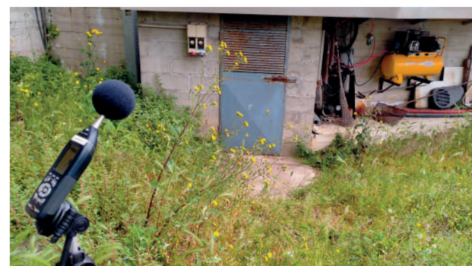
Misurazioni fonometriche per valutazioni di impatto acustico
