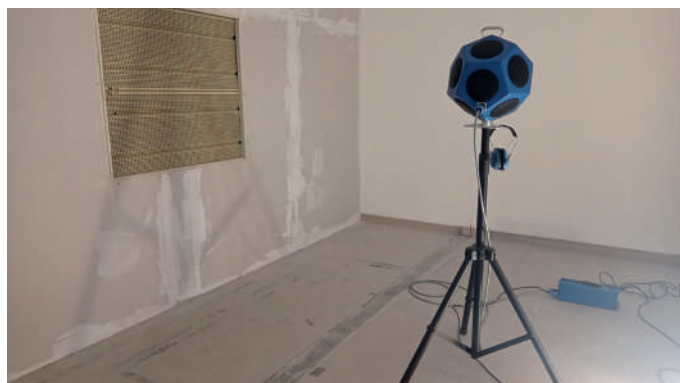
Misura dell'assorbimento acustico in camera riverberante
