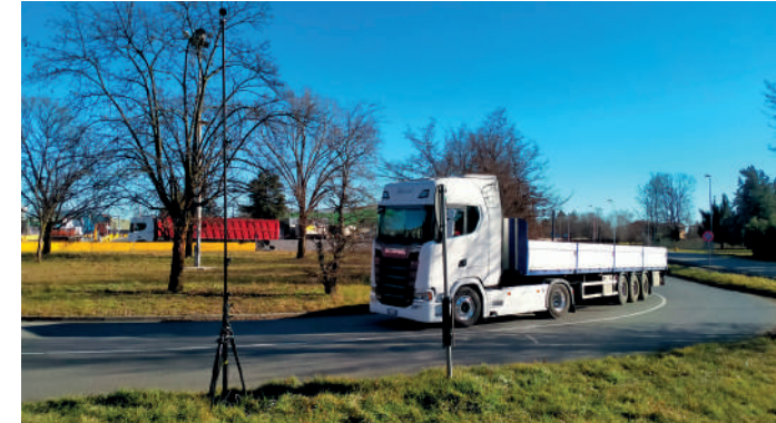
Misurazioni fonometriche per valutazioni di impatto acustico
