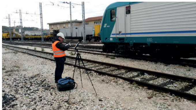
Postazione fonometrica all'interno del sedime ferroviario
