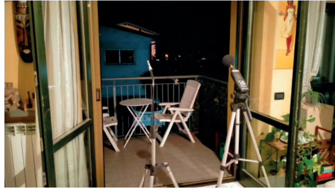
Postazione di misura fonometrica n.1
