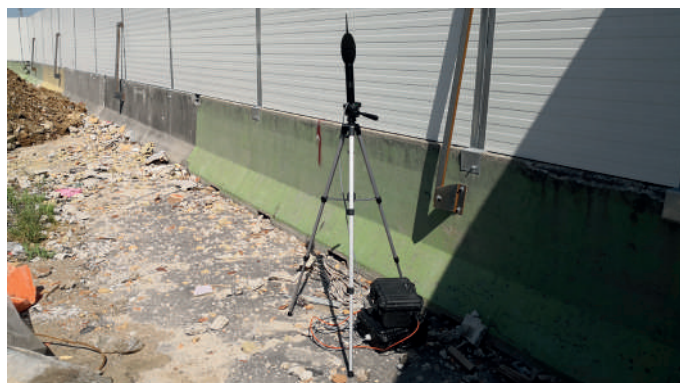
Postazione di misura fonometrica al confine del cantiere
