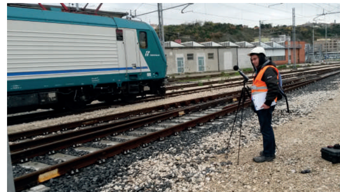
Postazione fonometrica all'interno del sedime ferroviario
