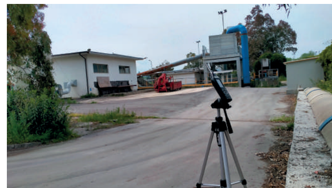
Misurazioni fonometriche per valutazioni di impatto acustico
