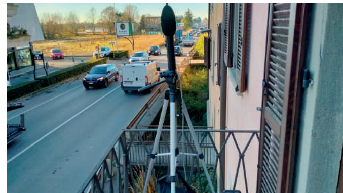
Postazione fonometrica presso ricettore privato per la valutazione del clima acustico in Ante Operam
