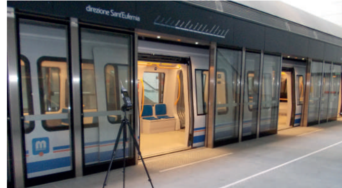
Misure fonometriche in ambienti di stazione
