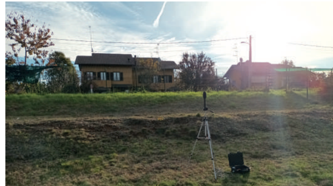
Postazioni fonometriche per la valutazione del clima acustico della futura area del polo scolastico
