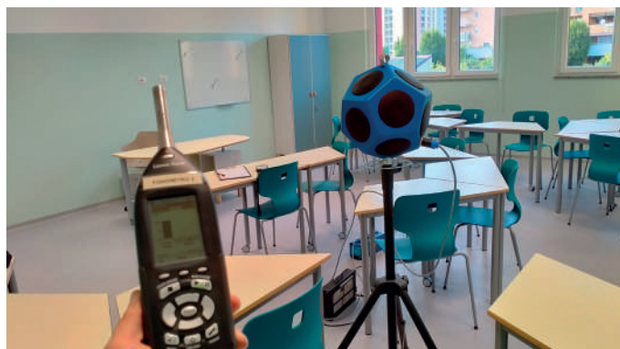
Misura del potere fonoisolante apparente di parete
