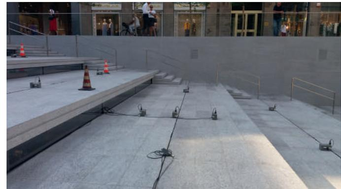
*Posizione degli accelerometri sulla scalinata*
