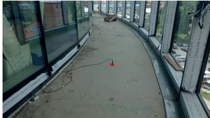
Posa di accelerometri sulla struttura
