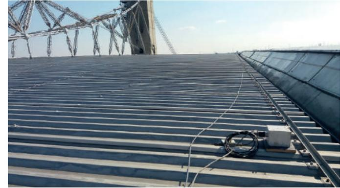
*Posizione di terna accelerometrica sulla copertura*
