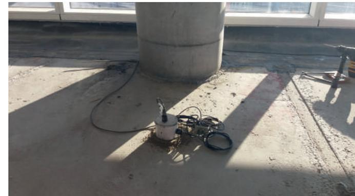
*Dettaglio di terna accelerometrica*
