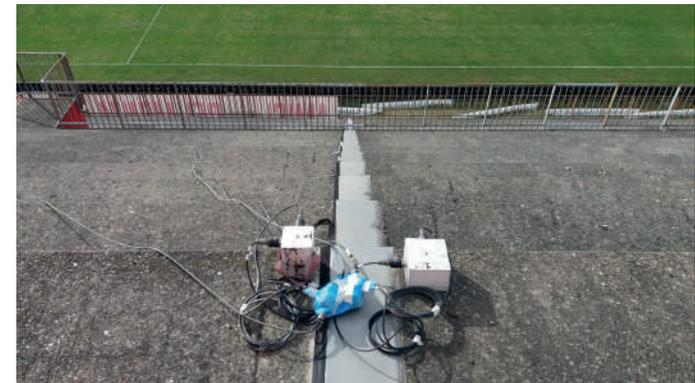
*Posizione di due terne accelerometriche su giunto strutturale*
