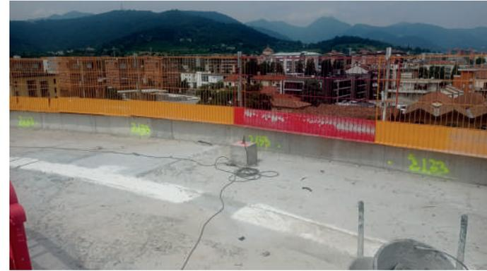
Posa di accelerometri sulla struttura
