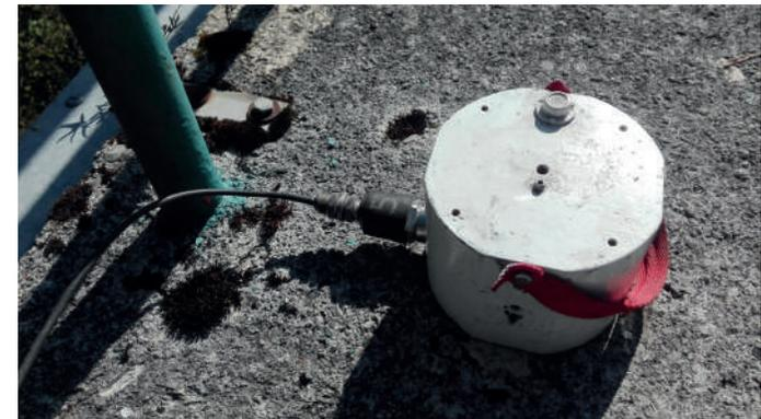
*Dettaglio di terna accelerometrica*
