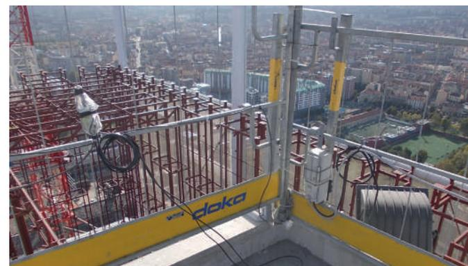
*Posizione di accelerometro sulla copertura dell'edificio*
