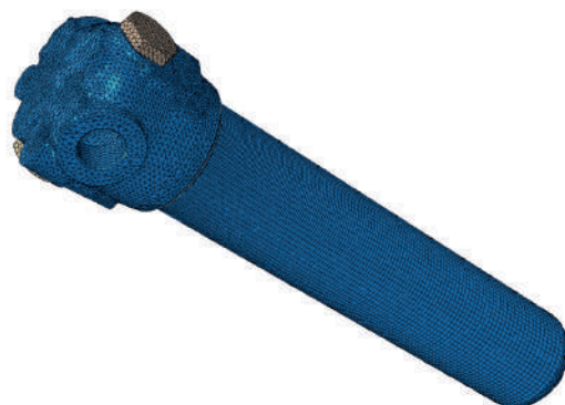
Testata e serbatoio del filtro oggetto di analisi
