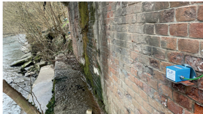
Clinometro biassiale di superficie IP68
