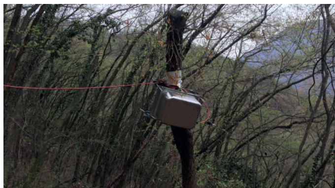
Estensimetri a filo sezione centrale
