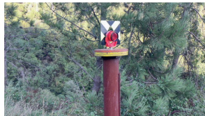
Mira su testa di tubo inclinometrico
