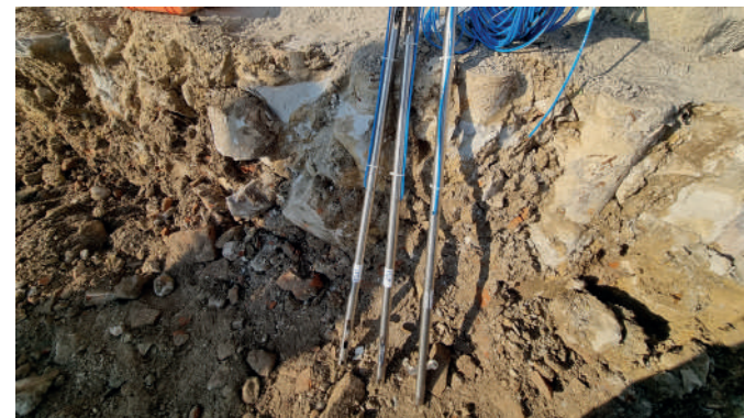
Dettaglio sonde inclinometriche fisse da tubo
