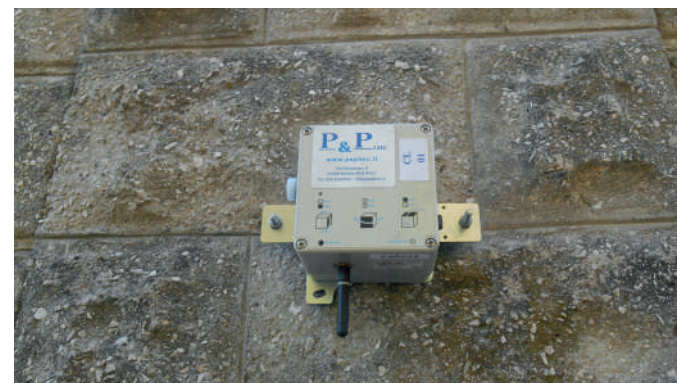
Installazione tipo inclinometro
