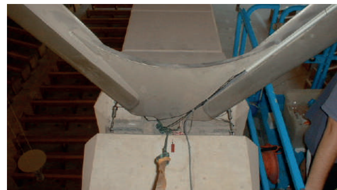
Deformometri installati all'estradosso
