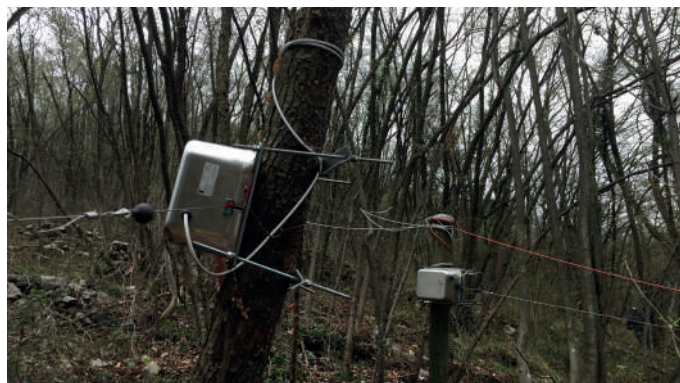
Estensimetri a filo sezione d'estremità
