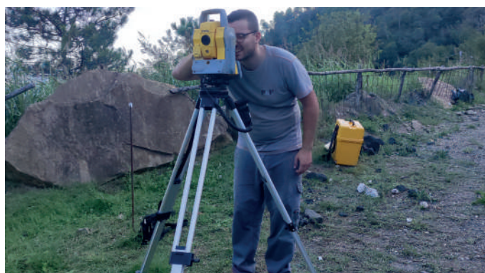
Operazione di lettura topografica con stazione totale
