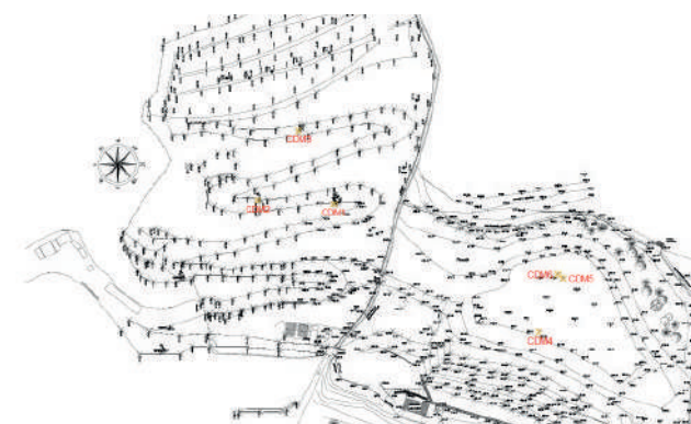
Planimetria con dislocazione dei n.6 tubi inclinometrici
