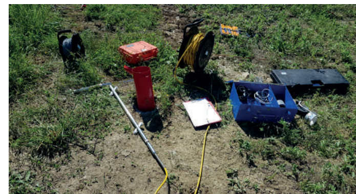
Attrezzatura per le letture inclinometriche
