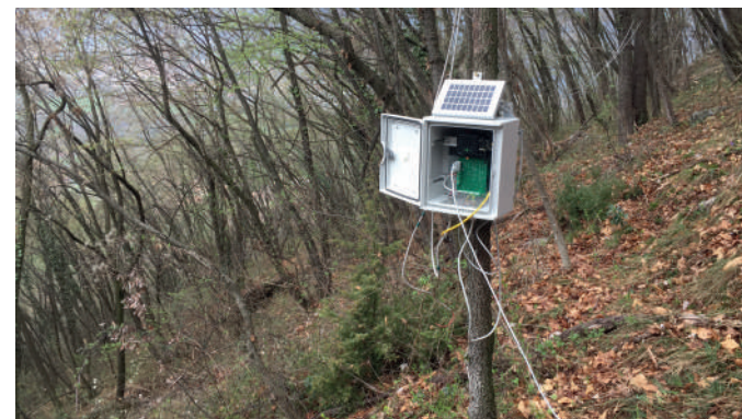
Unità di acquisizione e gateway
