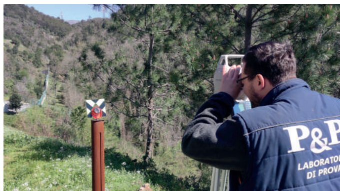
Operazione di lettura di mira su testa di tubo inclinometrico
