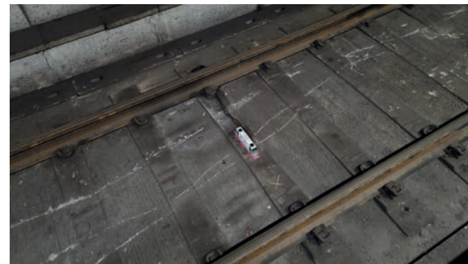
Inclinometro per rilevazione della geometria del binario
