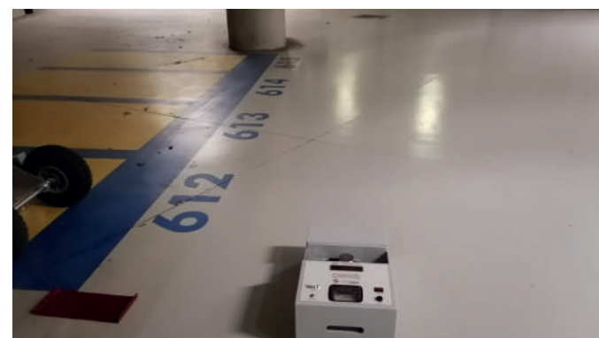
Prova di scivolosità su pavimentazione bagnata
