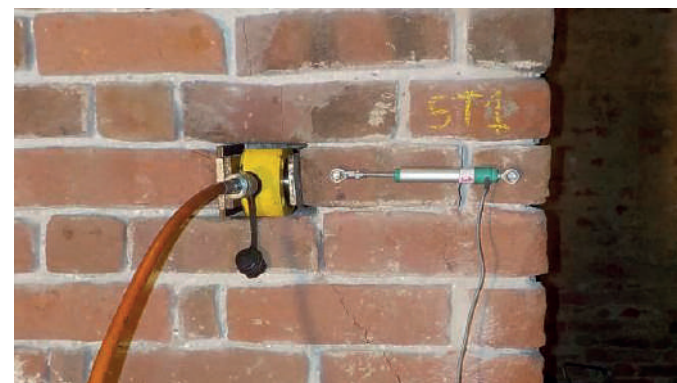
Esecuzione di prova shove test
