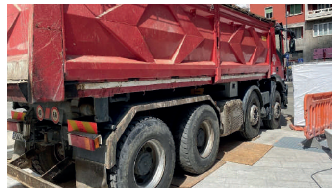
Esecuzione di prova di carico con automezzo
