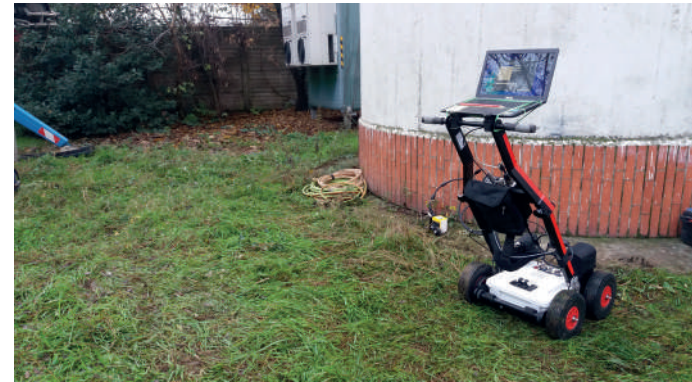
Indagine georadar per individuazione di fondazione
