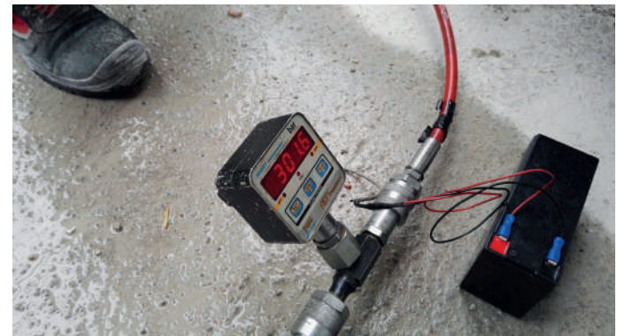
Cella di carico durante l'esecuzione della prova
