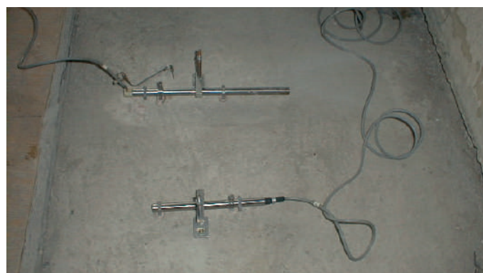
Misura di sollecitazione tramite sensore di deformazione
