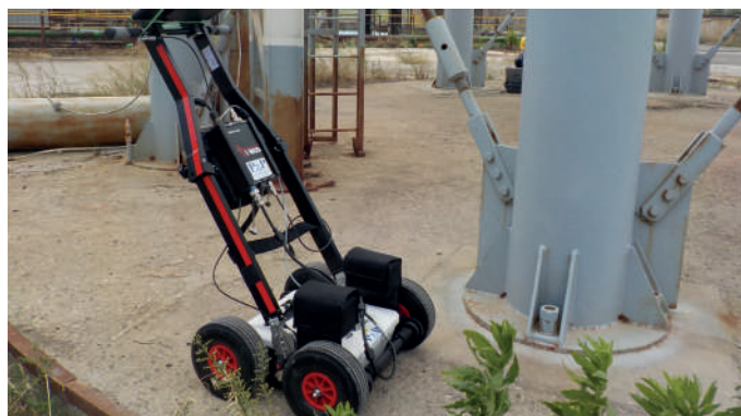
Indagine georadar per individuazione di fondazione
