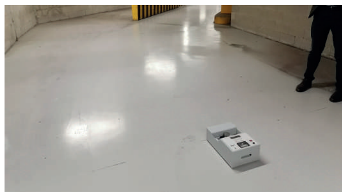
Prova di scivolosità su pavimentazione asciutta
