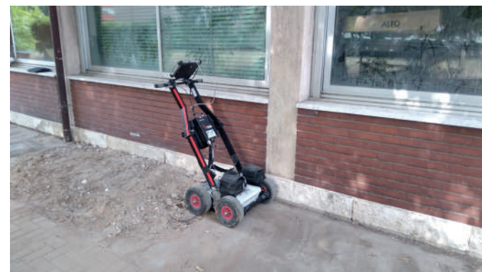
Esecuzione di indagine georadar
