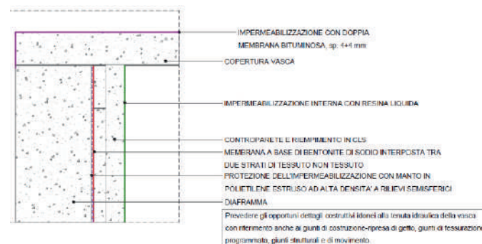
Dettaglio di impermeabilizzazione della copertura della vasca
