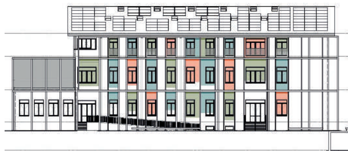
Prospetto della facciata principale con esoscheletro esterno
